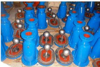
La boya-flotador normalmente usada en otras ventosas presenta problemas en el cierre por deformaciones y adherencias; en las ventosas de la marca Multiplex son sustituidas por un sistema de palancas que multiplica la acción del flotador. El cierre se produce por elementos expresamente diseñados para cumplir esta labor.
