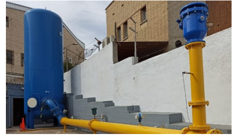
Capacidades de admisión y expulsión verificadas con nuestro banco de pruebas.
